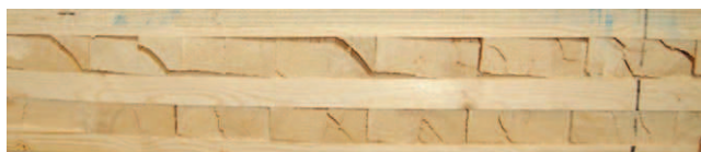
Rys. 4. Efekt przekroczenia wytrzymałości na ścinanie tarczowe (rolling shear) [7]
